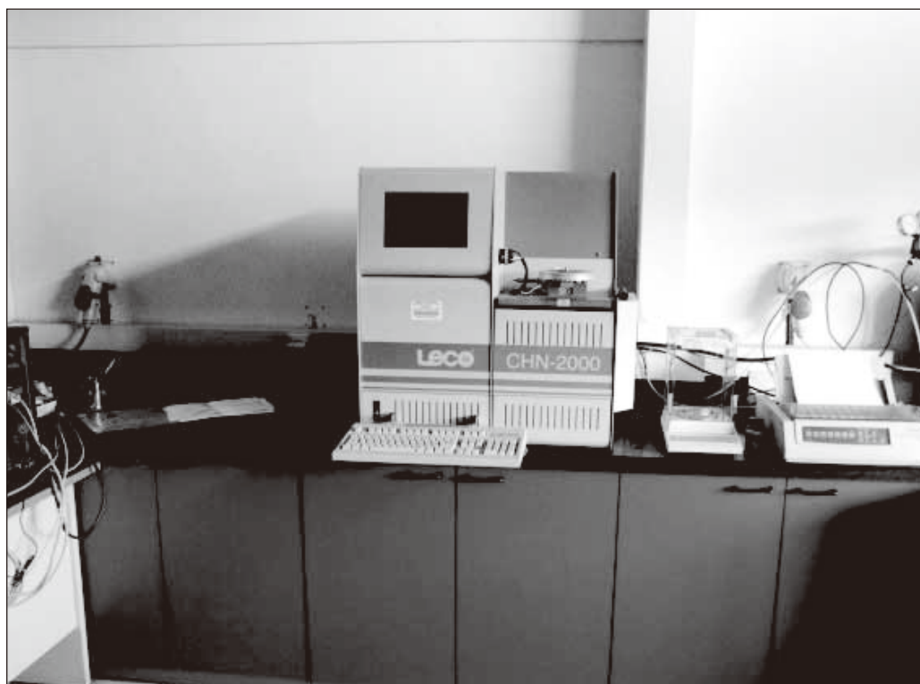
圖 7-4：TekMIRA 煤炭品質實驗室的LECO系統
