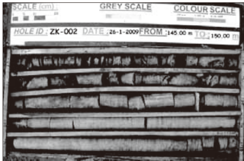
圖 11-2：MMHL 項目岩芯碟型破碎範例
